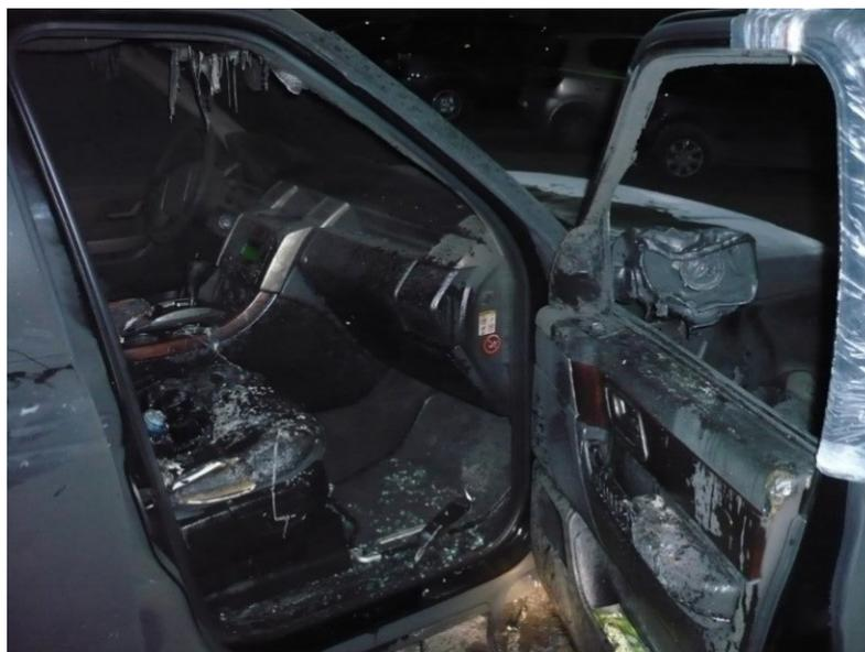
Рис. 1. Термические повреждения салона автомобиля с застывшим расплавом полимера на переднем пассажирском сиденье
