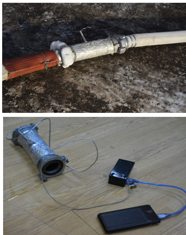
Рис. 1. Рукавные вставки различного диаметра с измерительным прибором и источником питания Fig. 1. Sleeve inserts of various diameters with measuring device and power supply
