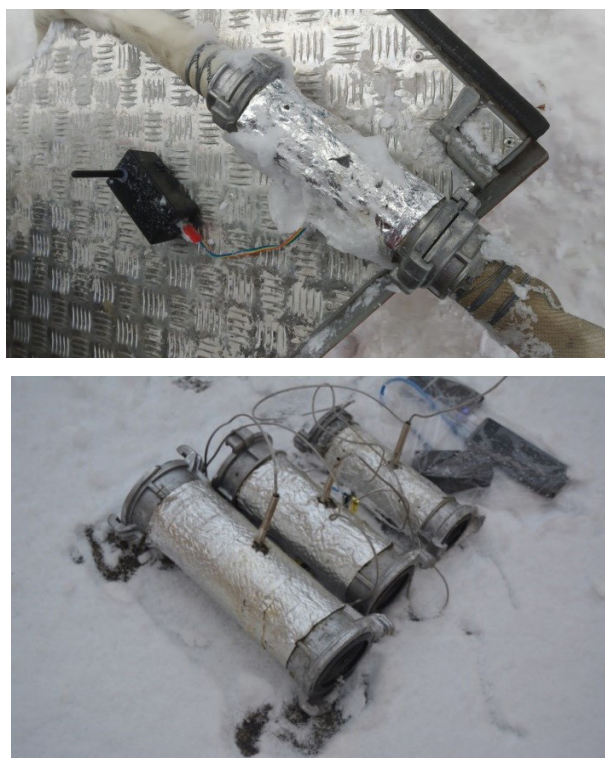
Рис. 1. Рукавные вставки различного диаметра с измерительным прибором и источником питания Fig. 1. Sleeve inserts of various diameters with measuring device and power supply
