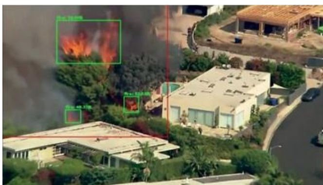
Рис. 2. Пример работы программы на видеофайле Fig. 2. An example of how the program works on a video file
