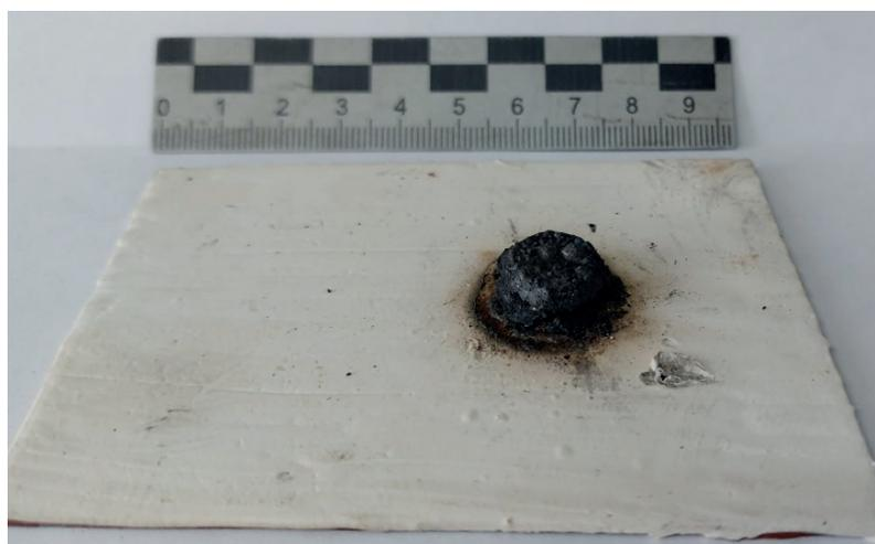
Рис. 4. Огнезащитное покрытие после проведенных испытаний
