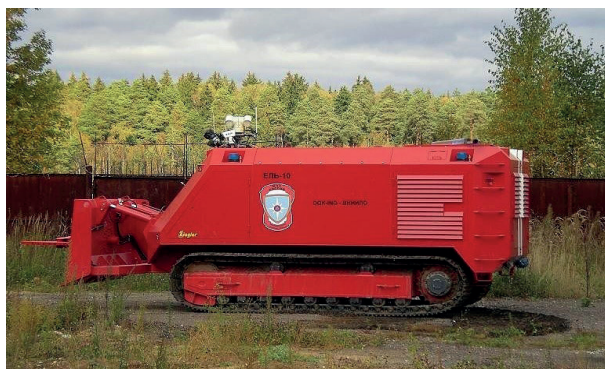
Рисунок 2. Пожарный робототехнический комплекс тяжелого класса «Ель-10»
