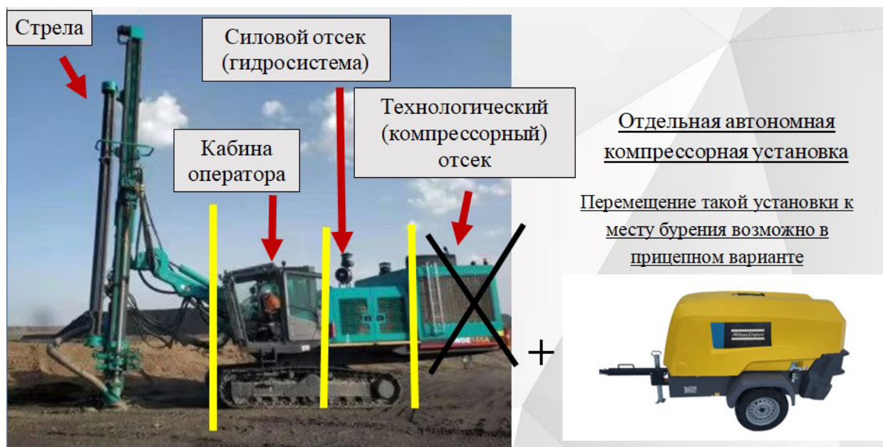
Рисунок 3. Модульная архитектура бурового станка SUNWARD SWDE 165A, состоящая из функциональных блоков отдельной автономной компрессорной установки
