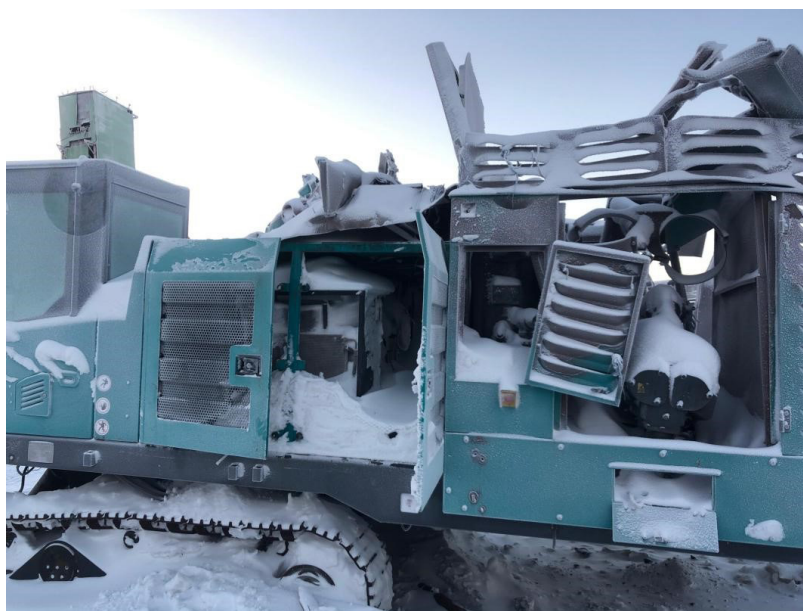
Рисунок 2. Вид бурового станка SUNWARD SWDE 165A с левой стороны с открытым боковым капотом моторного силового отсека с термическими повреждениями
