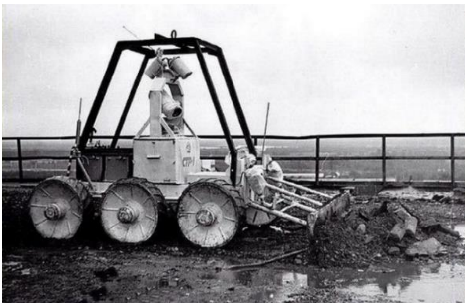
Рисунок 1. Телеуправляемый робот СТР-1 за работой по удалению радиоактивного графита на крыше машинного зала четвёртого энергоблока ЧАЭС (фото из открытых источников)
