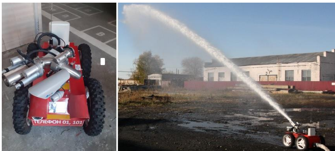
Рисунок 2. Мобильная радиоуправляемая установка пожаротушения МРУП 112 ВР (фото авторов и фото из открытых источников)
