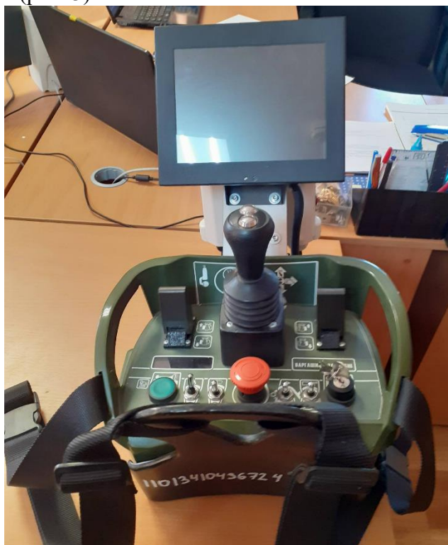
Рисунок 3. Пульт управления радиоуправляемой установки пожаротушения МРУП 112 ВР (фото авторов)
