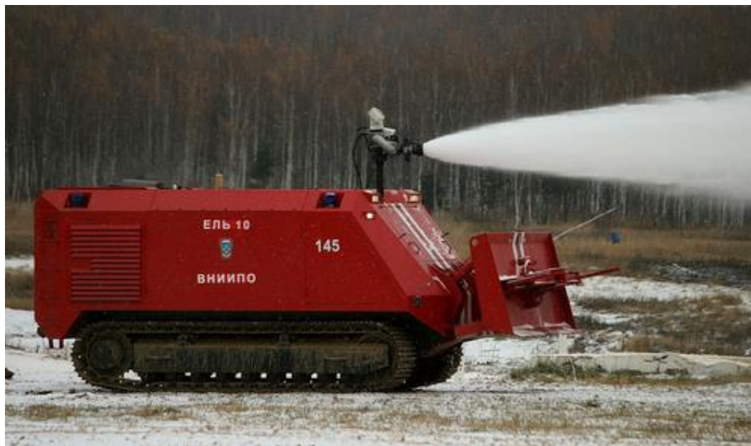
Рисунок 5. Робототехнический комплекс «ЕЛЬ-10» (фото из открытых источников)
