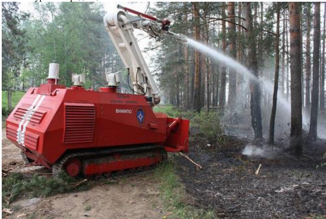
Рисунок 4. Робототехнический комплекс «ЕЛЬ-4» при тушении лесного пожара (фото из открытых источников)
