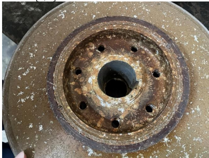
Рисунок 1. Рабочее колесо со следами абразивного и кавитационного износа
