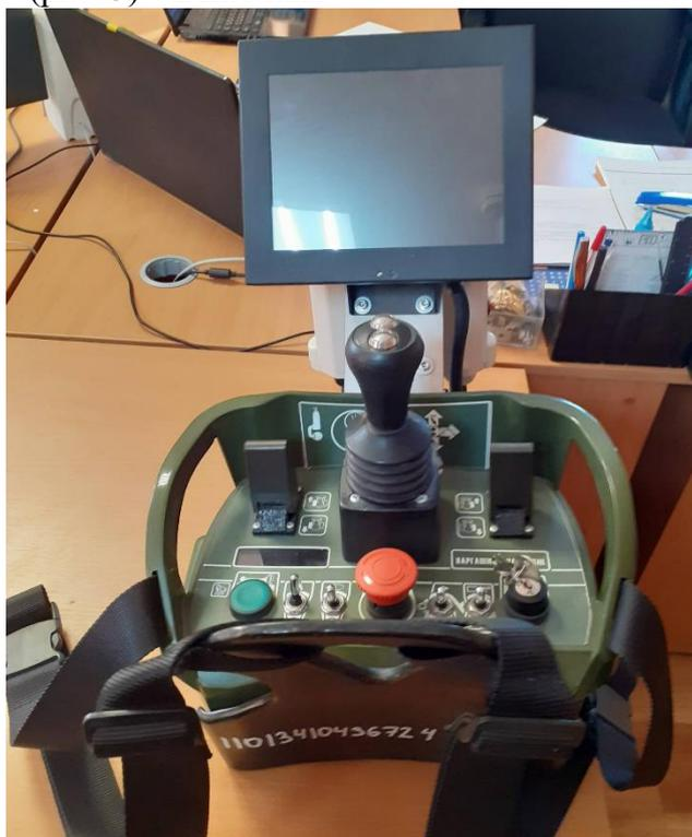
*Рисунок 3. Пульта управления радиоуправляемой установки пожаротушения МРУП 112 ВР (фото авторов)*
