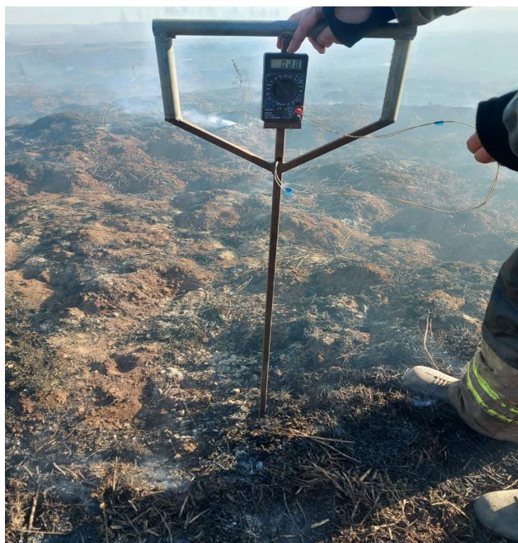
Рисунок 10. Контроль температуры нагретого слоя торфа при помощи щупа-термометра
