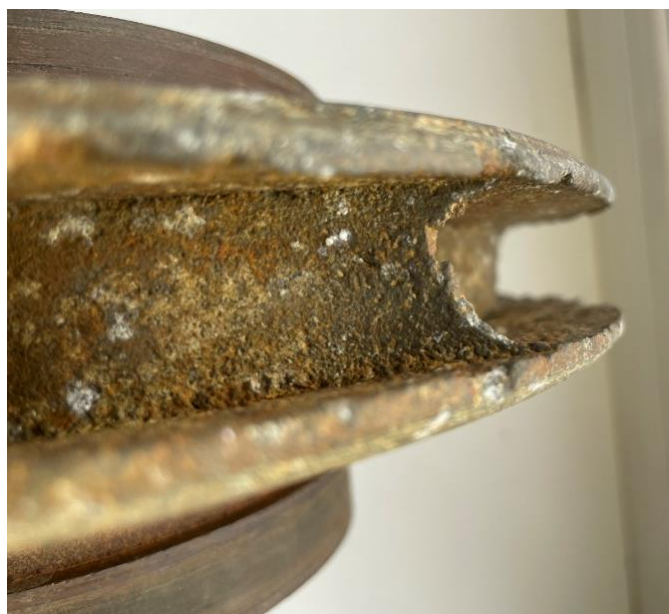
Рисунок 2. Лопастей рабочего колеса пожарного насоса с явными признаками кавитационного износа
