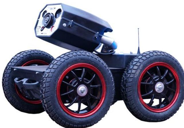
**Рис. 4.** Мобильная установка пожаротушения роботизированная (источник:<https://academygps.ru/about/structure/unk/fire-rescue-equipment/department-fire-engineering/developments-department/>)
