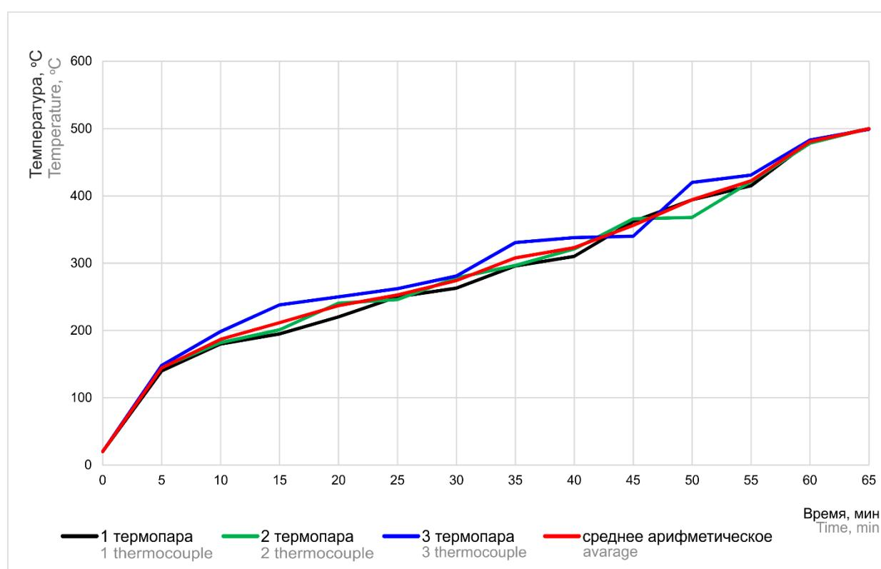
Рис. 1. Изменение температуры образца 1 при проведении огневых испытаний
