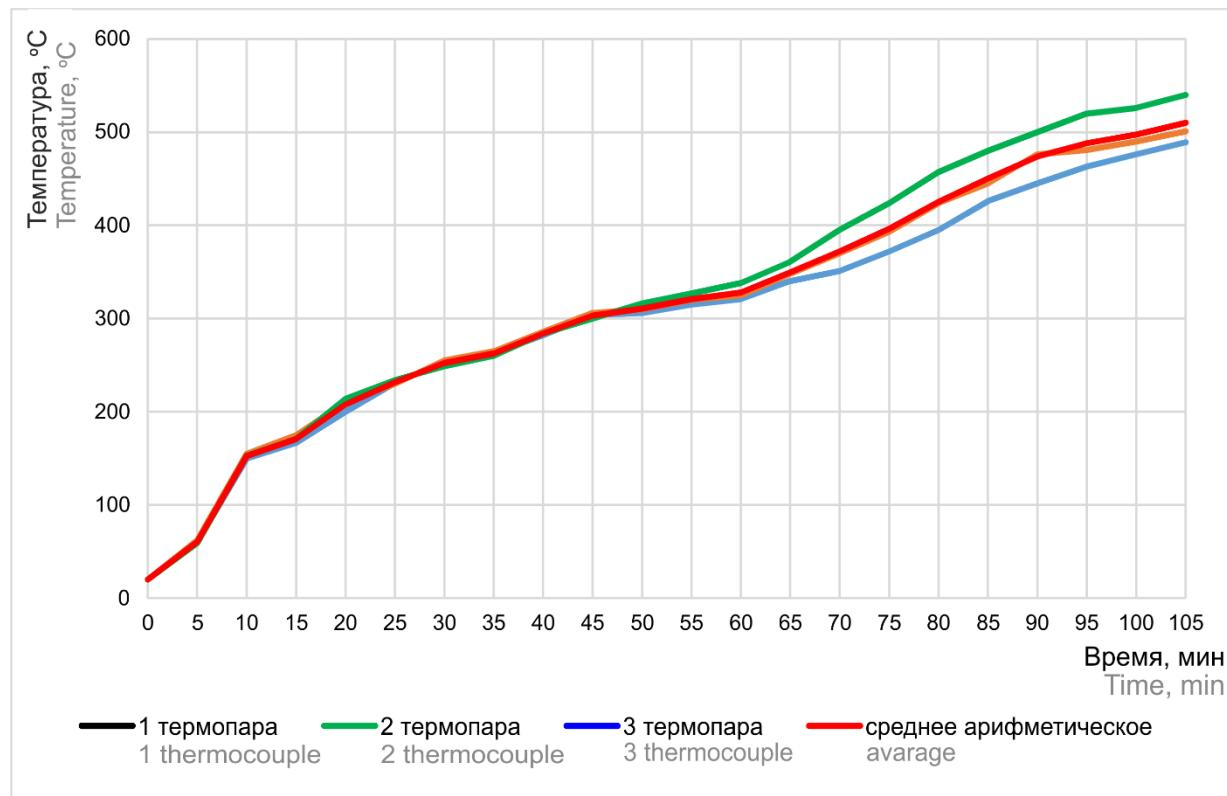
Рис. 2. Изменение температуры образца 2 при проведении огневых испытаний
