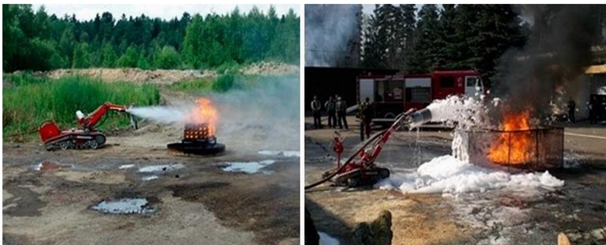
**Рис. 3.** Подача в очаг возгорания мобильным робототехническим комплексом огнетушащего вещества от порошкового (слева) и водопенного (справа) модулей пожаротушения (источник: <https://fireman.club/statyi-polzovateley/robototekhnicheskie-kompleksyi-mchs-osnovnyie-modeli-opisanie-i-tth>)
