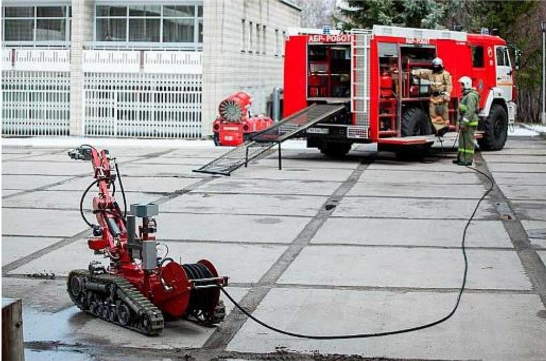
**Рис. 1.** Автомобиль быстрого реагирования и МРК-РП
