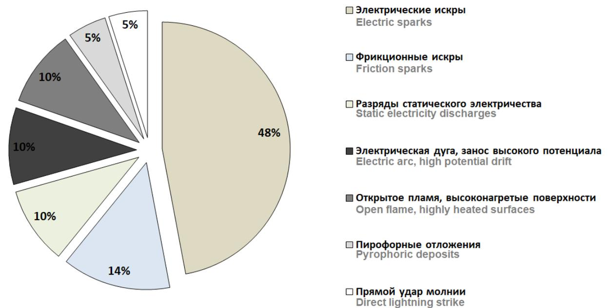
**Рис. 4.** Распределение причин пожаров на объектах хранения нефти и нефтепродуктов по типу источника зажигания
