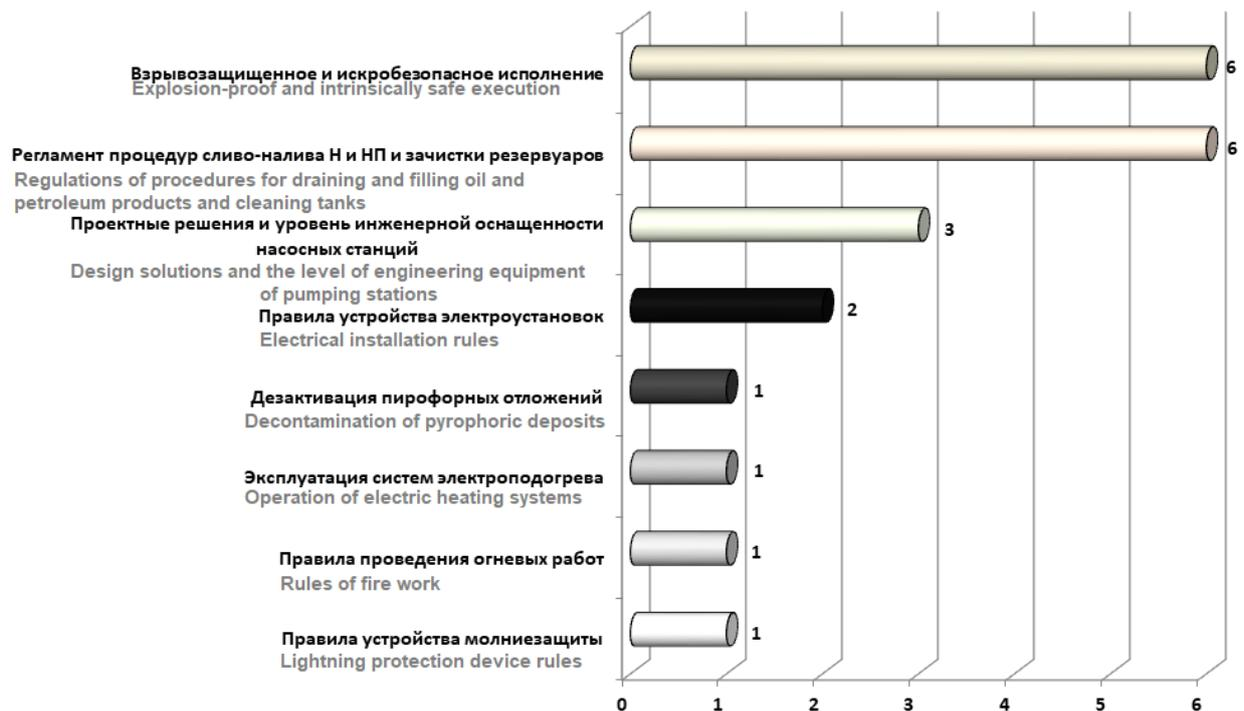
**Рис. 7.** Распределения пожаров на объектах хранения нефти и нефтепродуктов по области нарушений требований нормативно-технической базы
