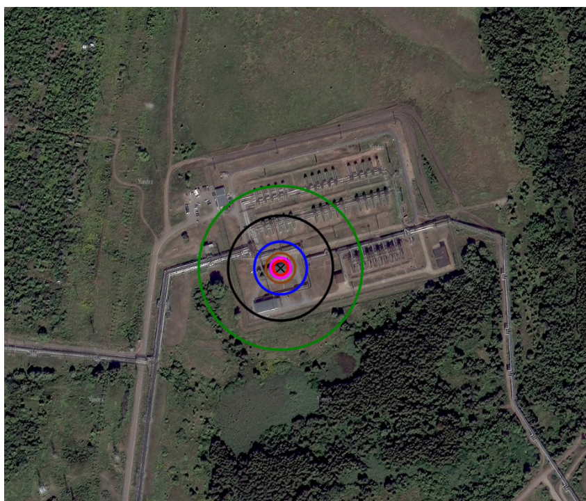
Рис. 3. Зоны поражения, рассчитанные по методике, изложенной в НПБ 105-03 и СП 12.13130.2009 Fig. 3. Affected areas calculated using the method described in NPB 105-03 and SP 12.13130.2009
