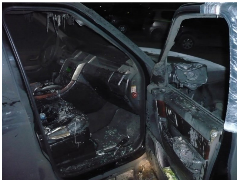
Рис. 1. Термические повреждения салона автомобиля с застывшим расплавом полимера на переднем пассажирском сиденье
