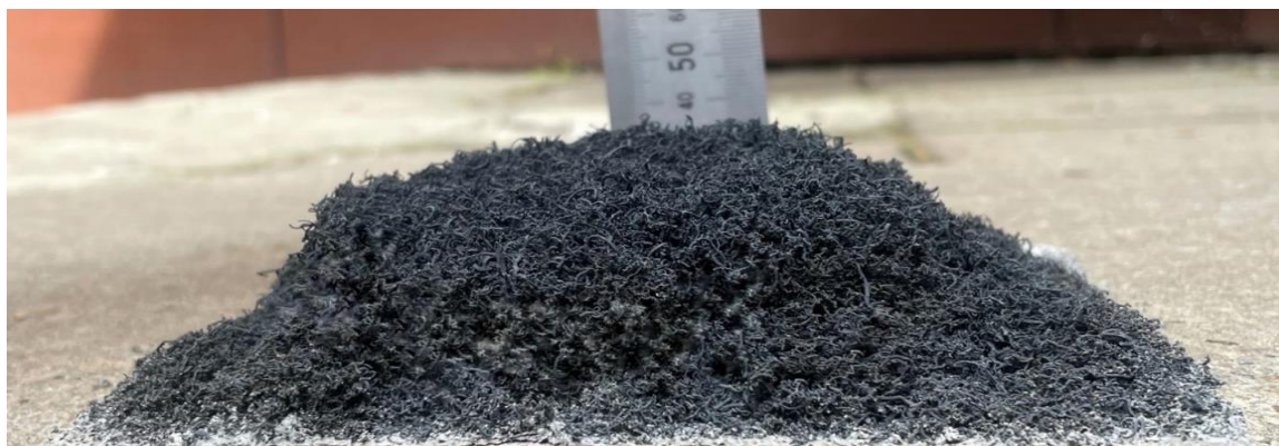
Рис. 10. Вспученный слой покрытия № 1 в результате термического воздействия теплового потока плотностью 25 кВт/м 2 (коэффициент вспучивания – K_{всп} = 28 )
