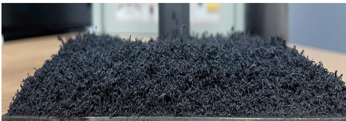
Рис. 11. Вспученный слой покрытия № 6 в результате термического воздействия теплового потока плотностью 35 кВт/м 2 ( K_{всп} = 16 )
