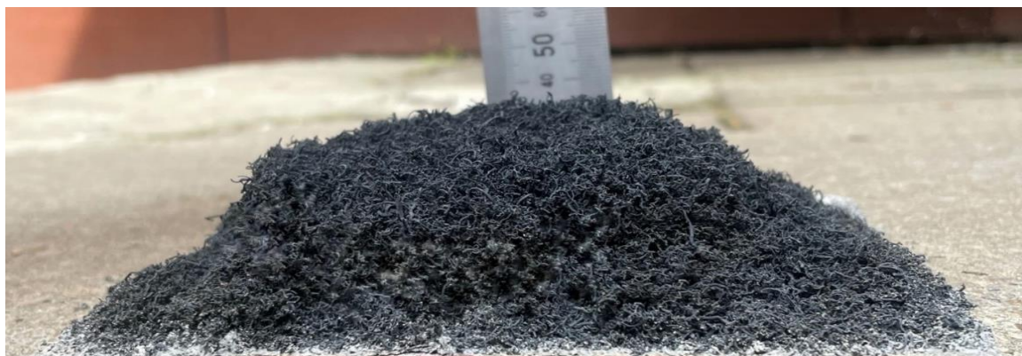
Рис. 10. Вспученный слой покрытия № 1 в результате термического воздействия теплового потока плотностью 25 \text{ кВт/м}^2 (коэффициент вспучивания – K_{\text{всп}} = 28 )
