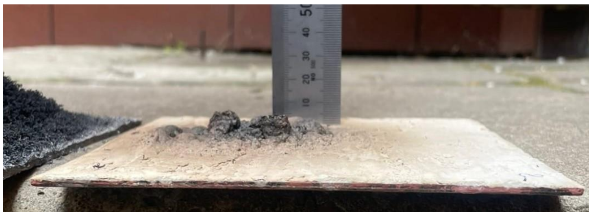
Рис. 9. Вспученный слой покрытия № 3 в результате термического воздействия теплового потока плотностью 25 \text{ кВт/м}^2
