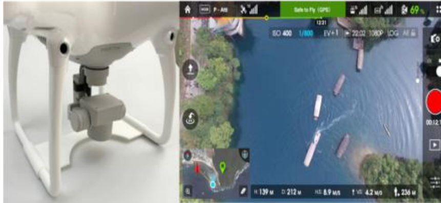
Рис. 6. Положение камеры для осуществления оперативной аэрофотосъемки с целью построения ортофотоплана
