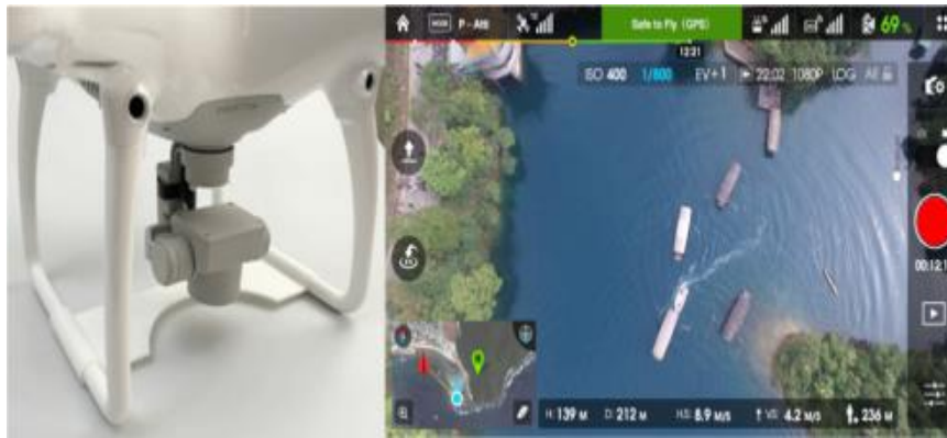
Рис. 6. Положение камеры для осуществления оперативной аэрофотосъемки с целью построения ортофотоплана
