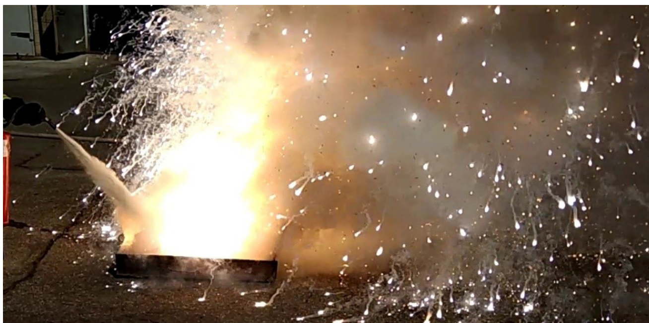
Рис. 2. Тушение непрессованной стружки магниевых сплавов порошковым огнетушителем ОП-8
