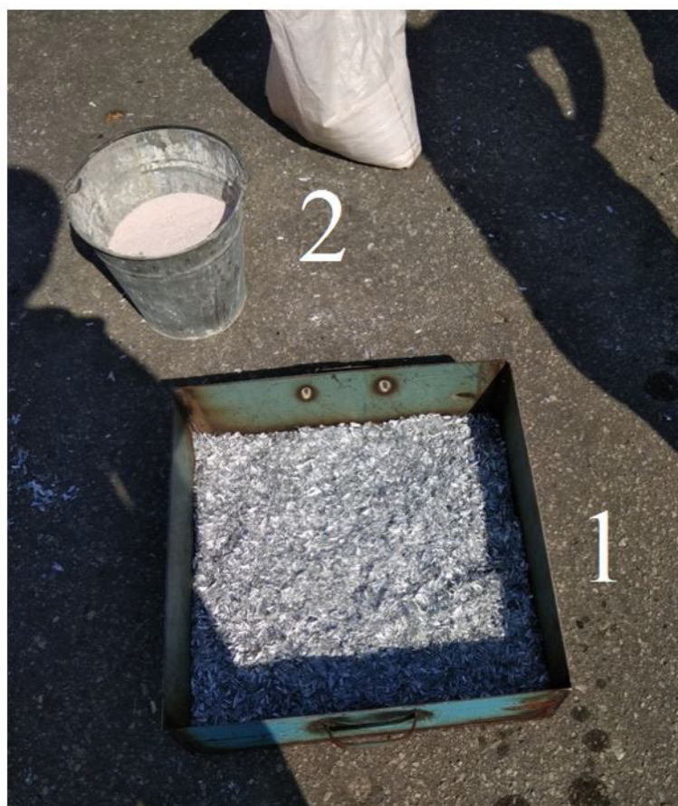
Рис. 1. Подготовка к проведению эксперимента: 1 — противень с непрессованной стружкой магниевых сплавов; 2 — емкость для измерения объема с сухим молотым флюсом
