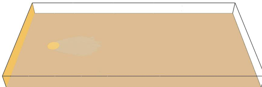
Рис. 4. Расчетная модель изоповерхности разлива СПГ объемом 34 м³ на расстоянии 0–250 м от места разлива. Время после начала разлива СПГ — 60 с. Температура СПГ — от –160 до –40 °С и ниже. Температура окружающей среды — +33,8 °С, скорость ветра — 5,4 м/с
