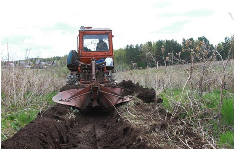
Рисунок 8. Тушение пожара с использованием заградительных полос
