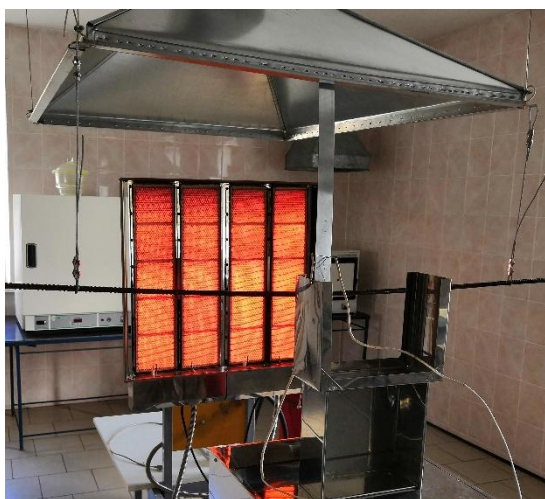
Рисунок 1. Образец для испытания (стальная арматура диаметром 10 мм) закреплена на установке в процессе испытания
