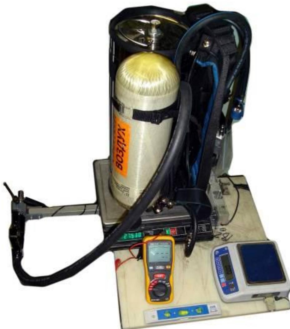
*Рисунок 1. Часть тензометрического стенда
