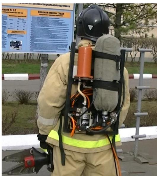
Рисунок 1. Пневмоприводной насос ГАСИ
