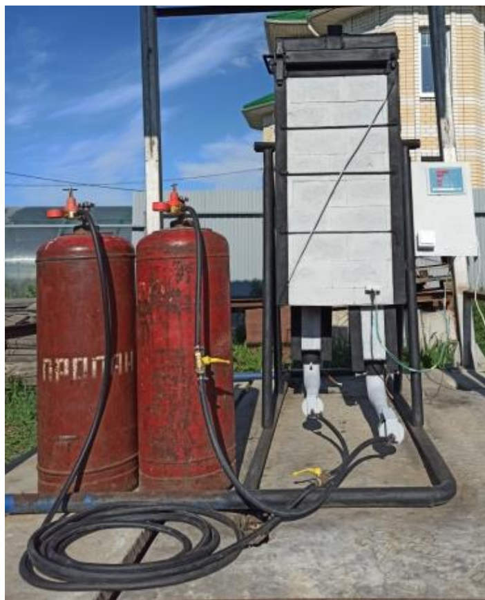
Рисунок 1. Испытательная установка для проведения натуральных огневых испытаний кабельных изделий с нанесенным ОКП при температурном режиме стандартного пожара
