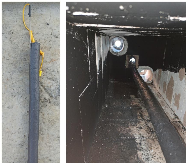
Рисунок 6. Фрагмент кабельного изделия с нанесенным ОКП № 1 и его размещение в испытательной установке
