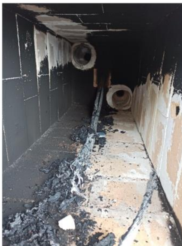
Рисунок 5. Фрагменты кабельного изделия без ОКП после проведения огневых испытаний в вертикальном (а) и горизонтальном (б) положениях
