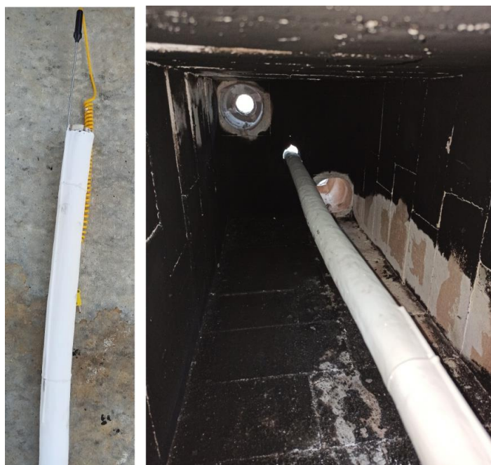
Рисунок 9. Фрагмент кабельного изделия с нанесенным ОКП № 2 и его размещение в испытательной установке
