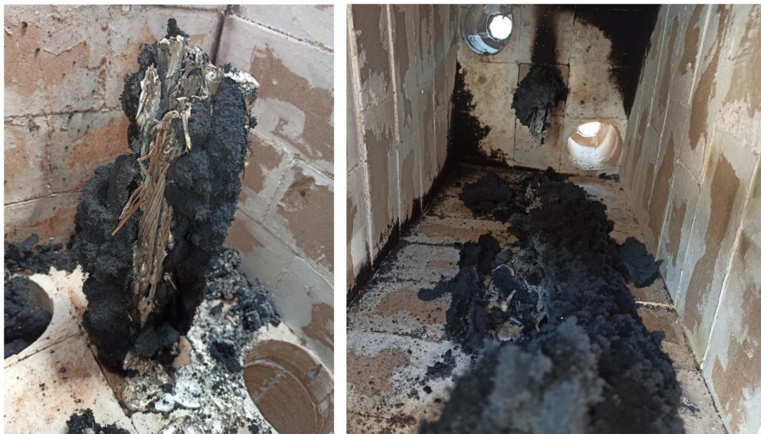
Рисунок 8. Фрагменты кабельного изделия с нанесенным ОКП № 1 после проведения огневых испытаний в вертикальном (а) и горизонтальном (б) положениях
