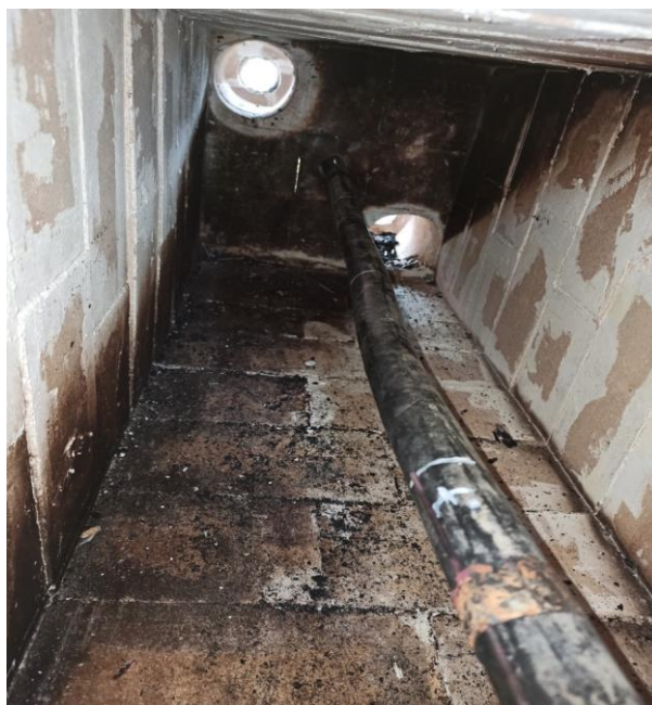
Рисунок 4. Размещение кабельного изделия с термопарами в испытательной установке
