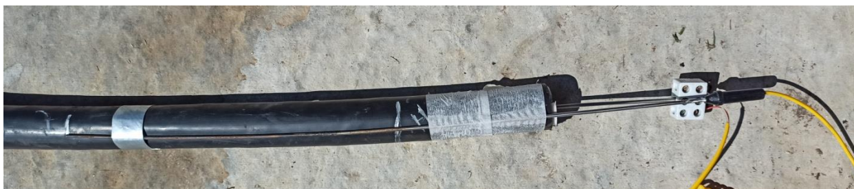
Рисунок 3. Размещение термопар на кабельном изделии
