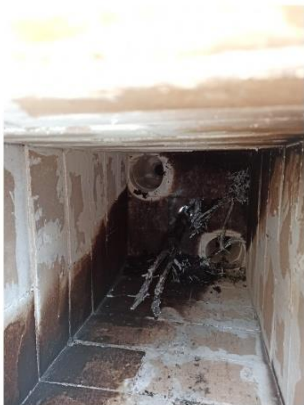
Рисунок 5. Фрагменты кабельного изделия без ОКП после проведения огневых испытаний в вертикальном (а) и горизонтальном (б) положениях
