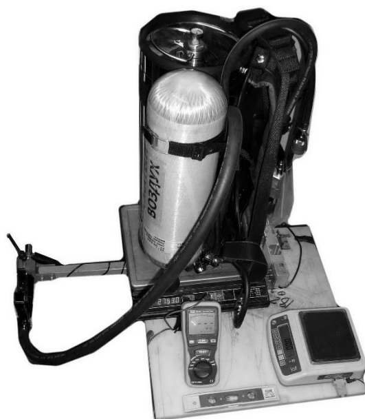
Рисунок 1. Часть тензометрического стенда с установленным на нем устройством для распыления
