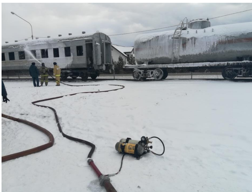
Рисунок 2. Формируемая при помощи мотопомпы компрессионная пена
