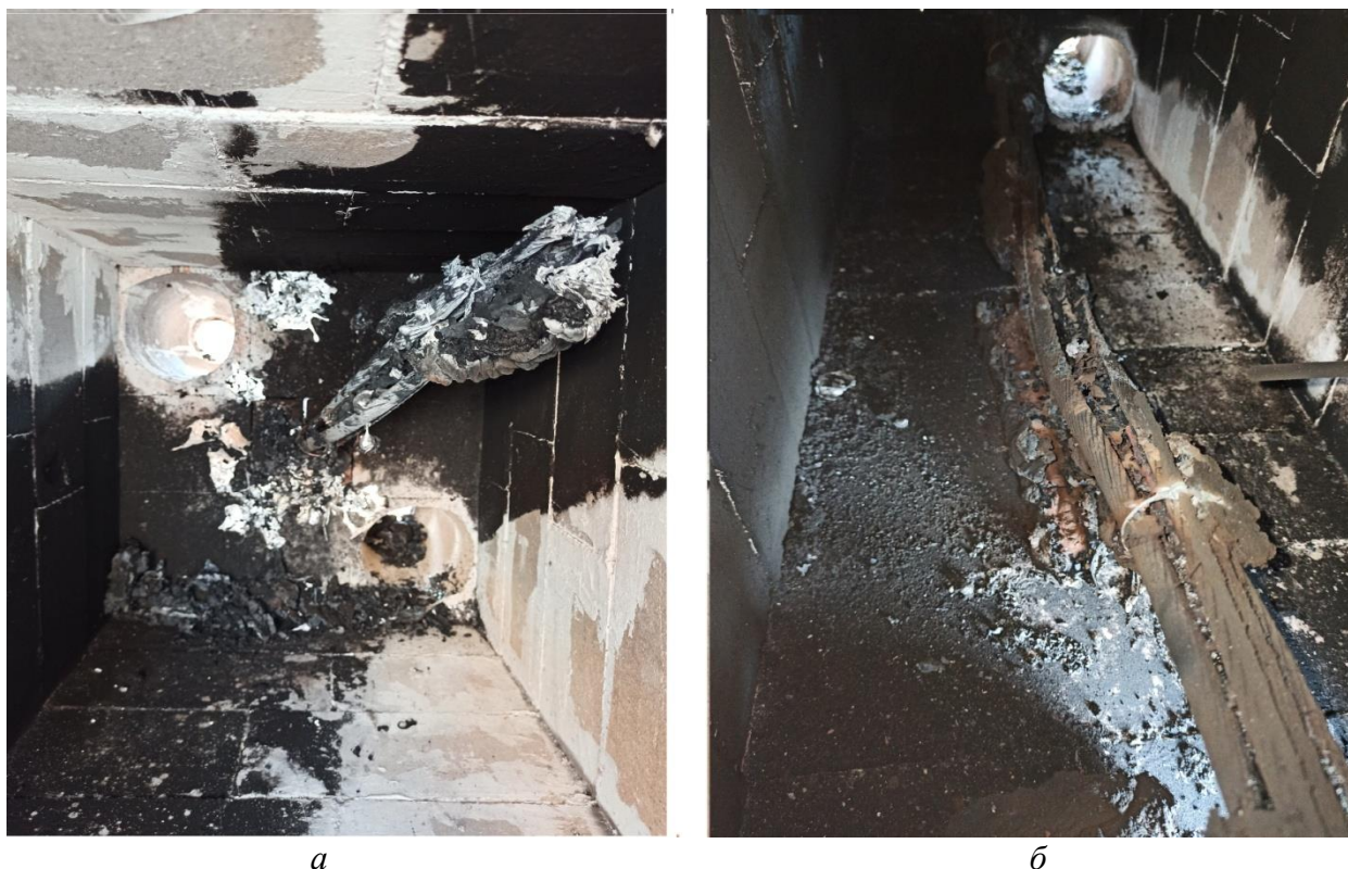
Рисунок 2. Фрагменты кабельного изделия с ОКП № 3 после проведения огневых испытаний при вертикальной (а) и горизонтальной (б) ориентации в пространстве
