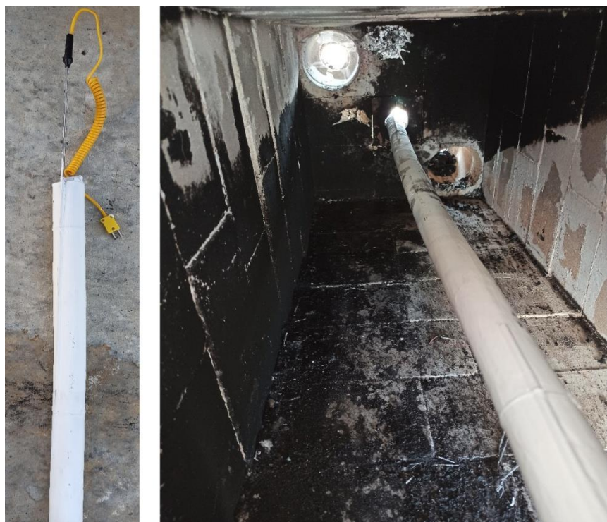
Рисунок 1. Размещение термодпар на кабельном изделии с нанесенным ОКП № 3 и кабельного изделия в испытательной установке
