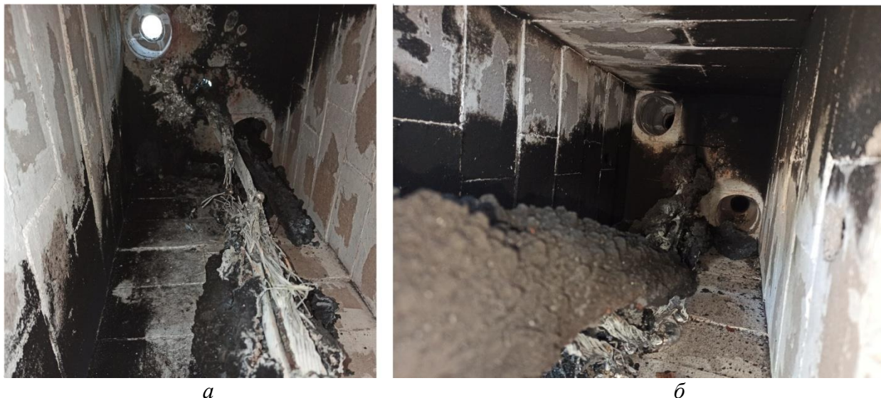
Рисунок 6. Фрагменты кабельного изделия с ОКП № 4 после проведения огневых испытаний при вертикальной (а) и горизонтальной (б) ориентации в пространстве
