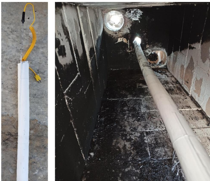
Рисунок 1. Размещение термопар на кабельном изделии с нанесенным ОКП № 3 и кабельного изделия в испытательной установке
