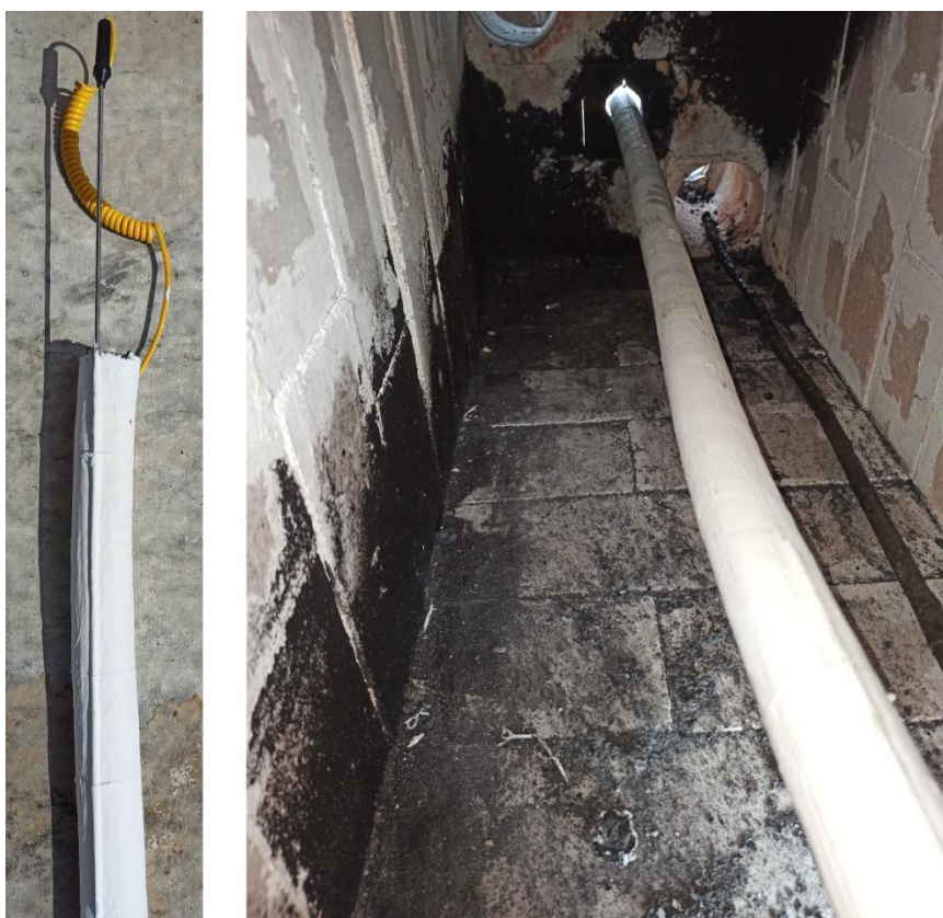
Рисунок 4. Размещение термопар на кабельном изделии с нанесенным ОКП № 4 и кабельного изделия в испытательной установке
