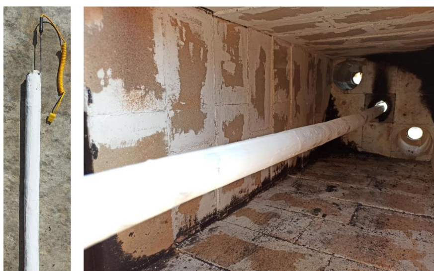
Рисунок 7. Размещение термопар на кабельном изделии с нанесенным ОКП № 5 и кабельного изделия в испытательной установке
