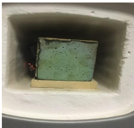
Рис. 3. Размещение образцов в муфельной печи
