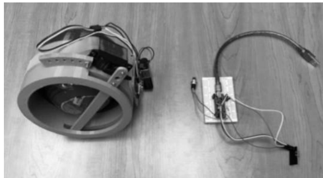
Рис. 8 Огнетушащие шары с ВГС и сбрасывающее устройство БПЛА
