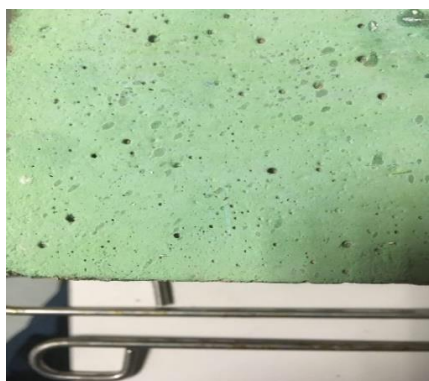
Рис. 2. ТИП на поверхности образца в один слой
