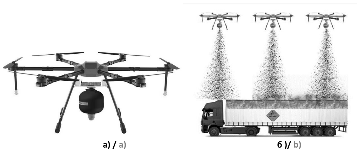
Рис. 9. а) Размещение МУП ТРВ на БПЛА; б) схема проведения водногелевой атаки БПЛА с МУП при тушении
