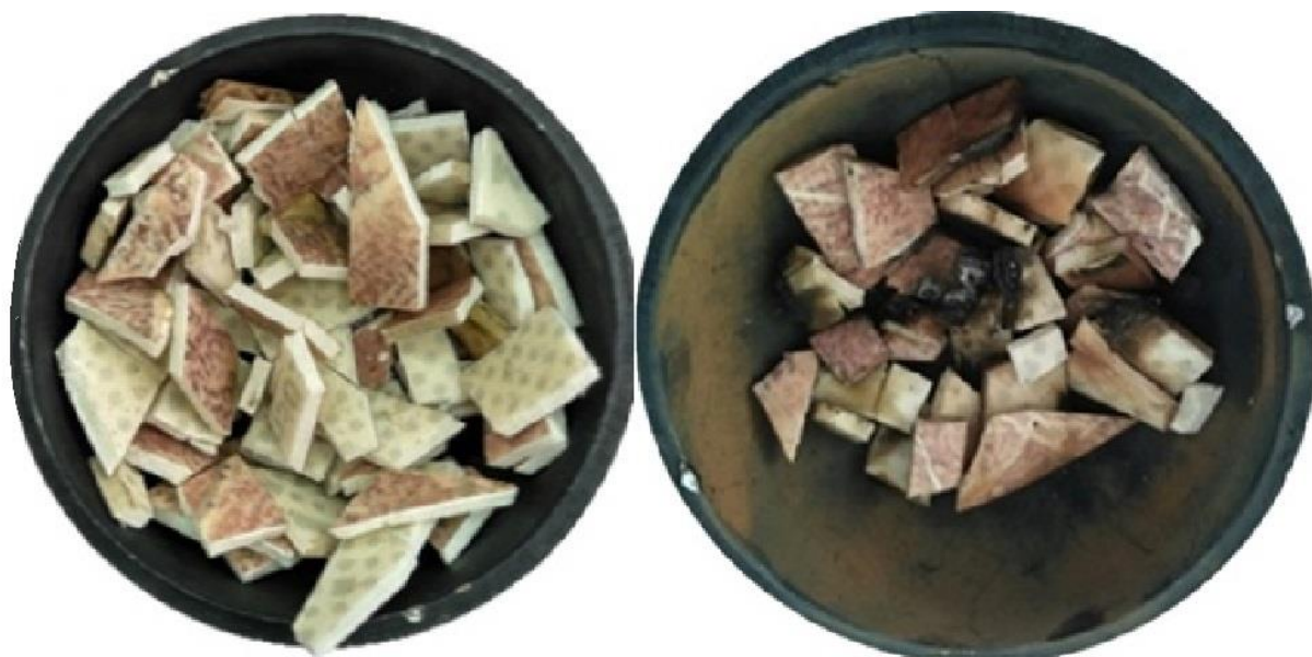
Рис. 3. Внешний вид образцов линолеума до и после зажигания Fig. 3. The appearance of linoleum samples before and after ignition
