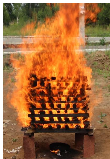
Рисунок 3. Устройство деревянного штабеля (модельного очага пожара А) для проведения испытаний
