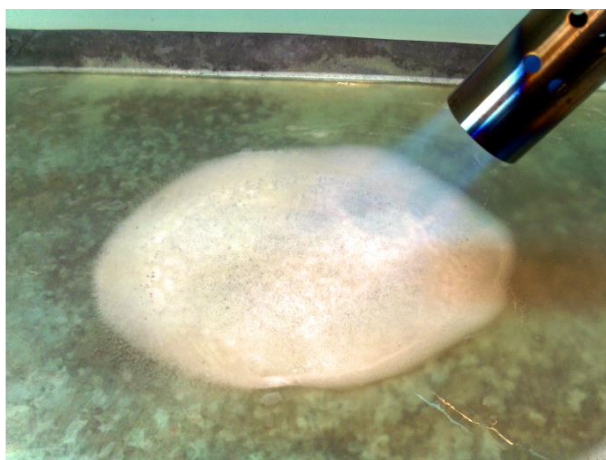
Рисунок 1. Вспенивание водного раствора, содержащего ПАВ и карбонатную соль аммония, при термическом воздействии на него пламенем газовой горелки
