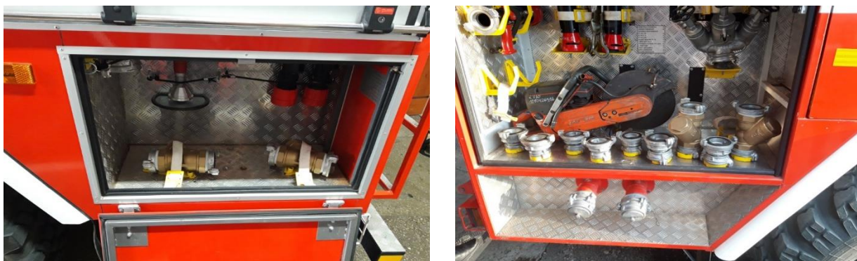
Рисунок 10. Пример монтажа и перевозки фильтра в отсеке пожарного автомобиля
