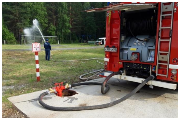
Рисунок 6. Работа пожарного ствола от пожарного автомобиля (АЦ), установленного на пожарный гидрант с фильтрами
