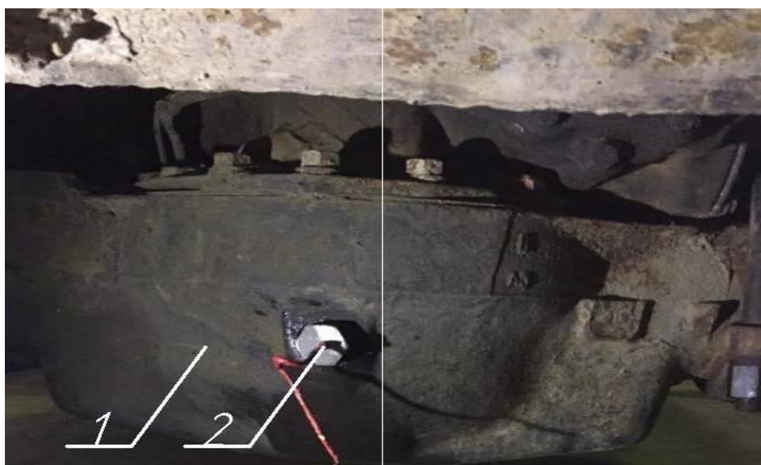
Рисунок 5. Вид ведущего моста АЦ-5,0-40 (3255) с датчиком температуры трансмиссионного масла, вмонтированного в пробку контрольного отверстия: 1 – картер ведущего моста; 2 – пробка с датчиком температуры
