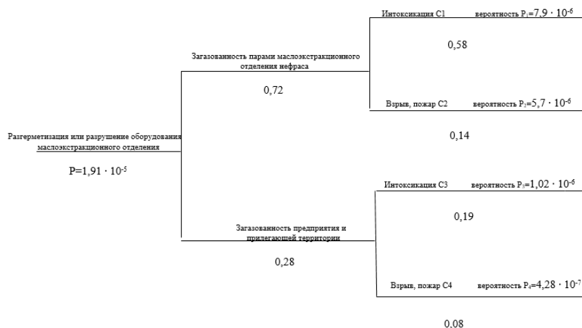
Рисунок 4. Дерево событий анализа причин аварии в маслоэкстракционном отделении и вероятности ее проявления в блоке № 6
