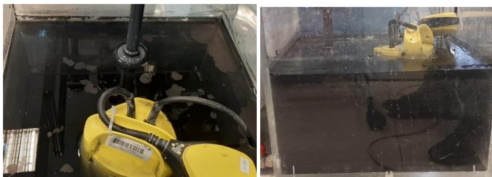
Рисунок 3. Резервуар с модельной водой
