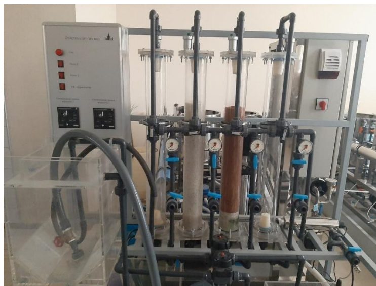
Рисунок 2. Учебный лабораторный стенд «Очистка сточных вод»
