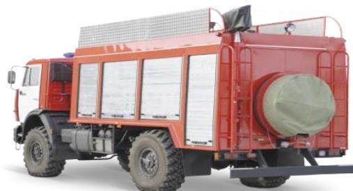
Рисунок 6. Автомобиль дымоудаления
