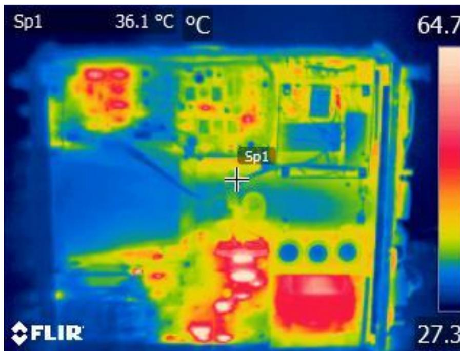
Рисунок 3. Плата с отдельными теплонагруженными электронными компонентами
