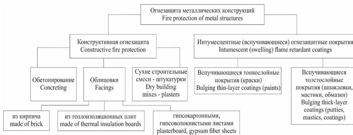
Рисунок. Виды огнезащиты металлических конструкций
