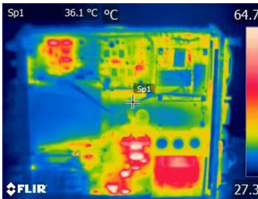
Рисунок 3. Плата с отдельными теплонагруженными электронными компонентами
