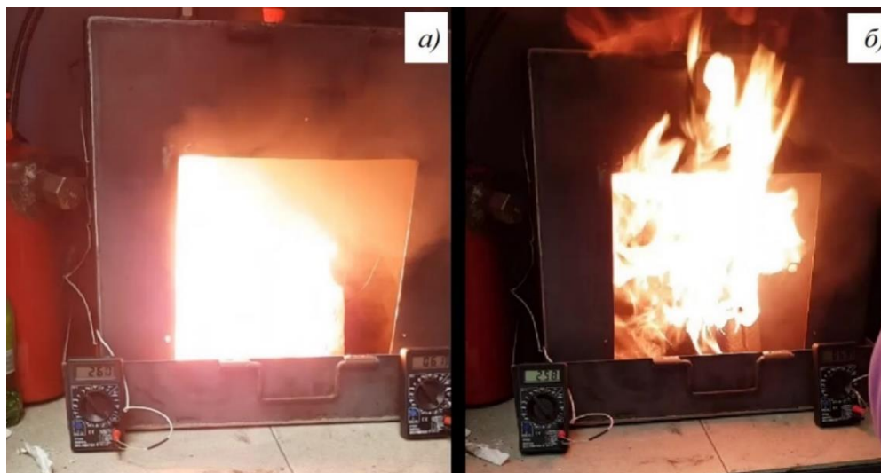
Рисунок 5. Фотография процесса тушения модельного очага с помощью ОТВ при концентрации УНС: 0,5 об. % (а), 1,0 об. % (б)
