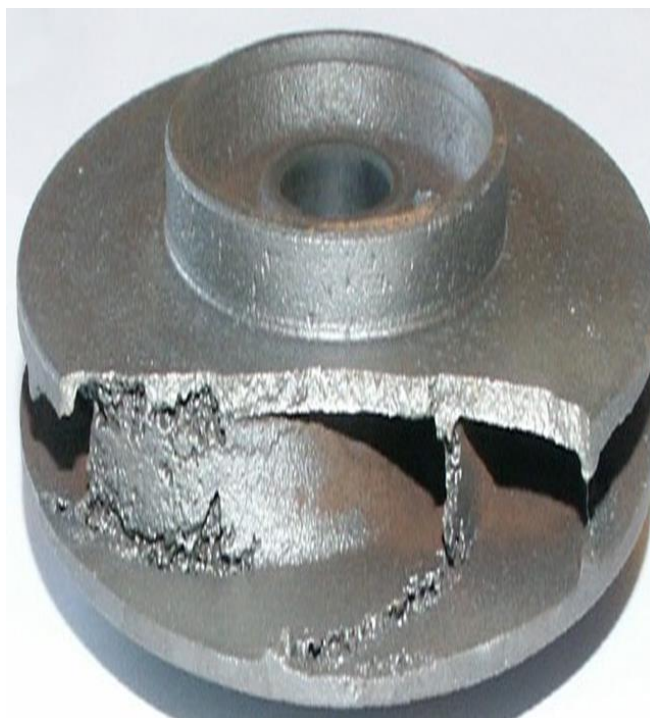
Рисунок 3. Повреждения рабочего колеса насосом наносимые эффекта кавитации
