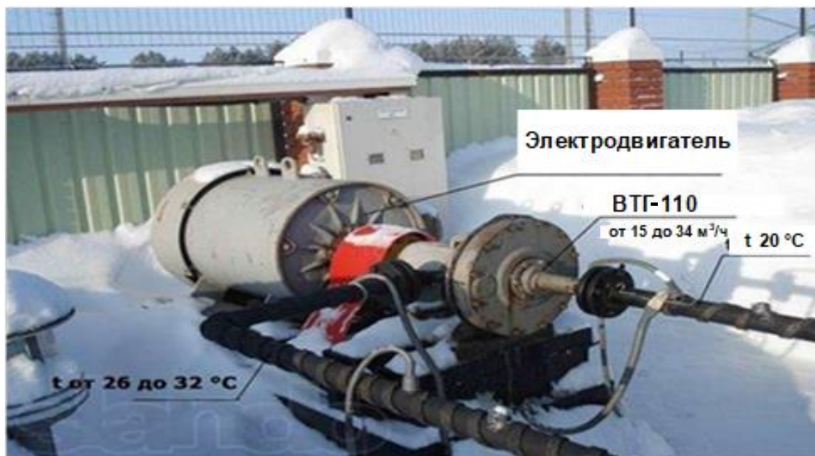
Рисунок 11. Вихревой кавитационный теплогенератор ВТГ-110 с электроприводом
