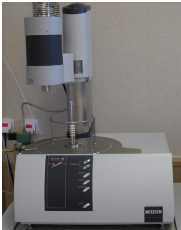
Рис. 1. Прибор синхронного термического анализа Netzsch STA 449 F5 Jupiter® Fig. 1. Synchronous thermal analysis instrument Netzsch STA 449 F5 Jupiter®
