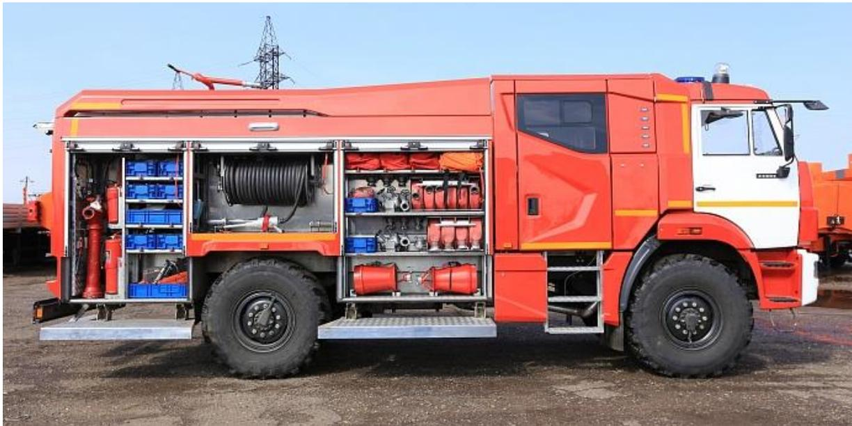
**Рис. 6.** АЦ-3,0-40 (43502) с системой тушения ТРВ HIROMAX
