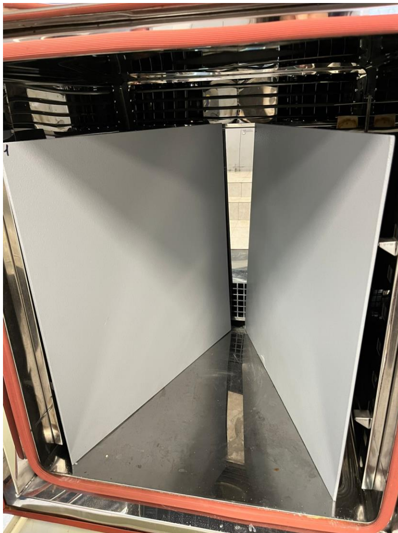
Рис. 1. Образцы в климатической камере TN-225 C перед началом испытаний Fig. 1. Samples in the TN-225 C climate chamber before the start of testing
