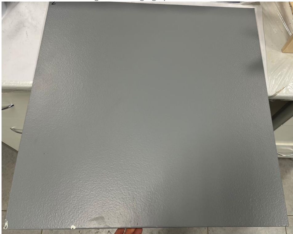
Рис. 3. Состояние системы покрытия после 134 цикла старения
