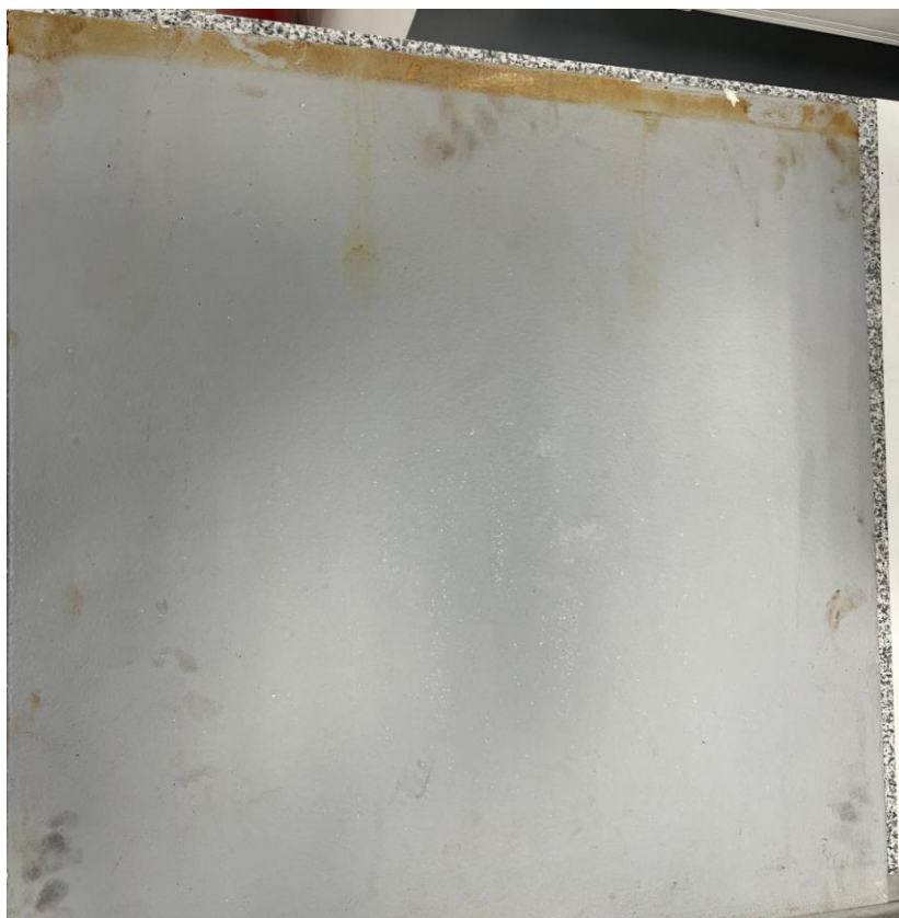
Рис. 4. Состояние системы покрытия после 224 циклов старения
