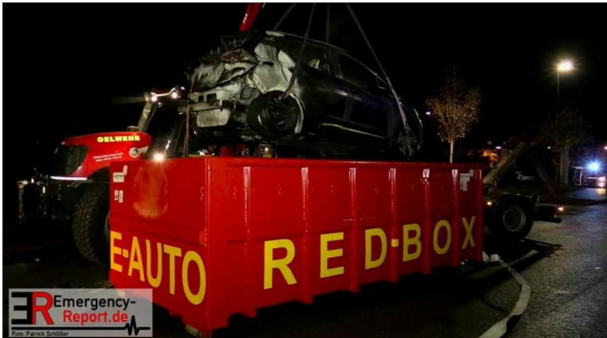
Рис. 6. Тушение электромобиля в водонаполненном контейнере
