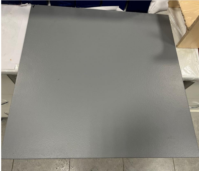
Рис. 2. Состояние покрытия после 45 циклов старения
