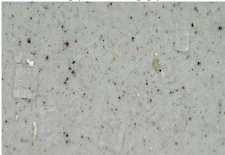
Рис. 5. Состояние поверхности системы покрытия после 224 циклов старения при 4-кратном увеличении микроскопа
