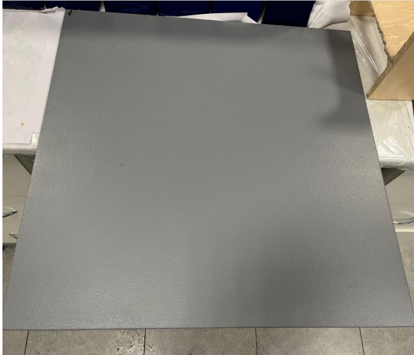
Рис. 2. Состояние покрытия после 45 циклов старения
