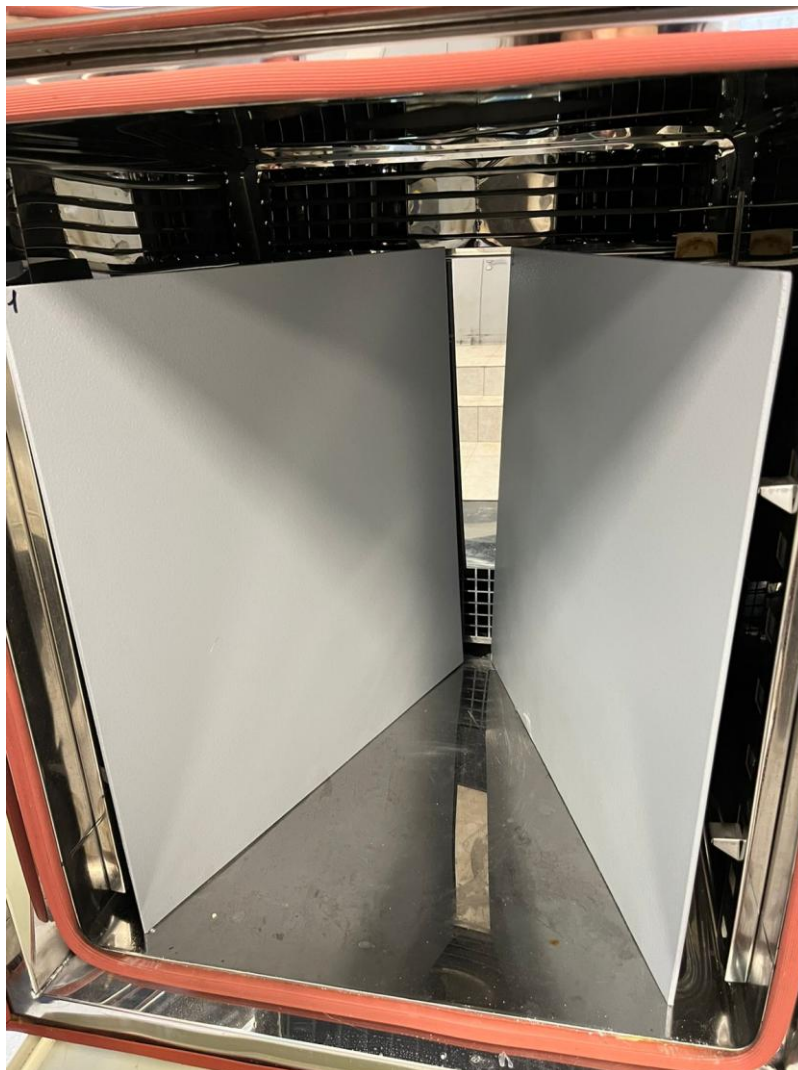
Рис. 1. Образцы в климатической камере ТН-225 С перед началом испытаний Fig. 1. Samples in the TN-225 C climate chamber before the start of testing
