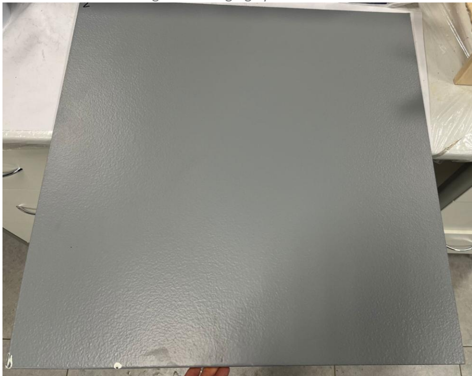
Рис. 3. Состояние системы покрытия после 134 цикла старения
