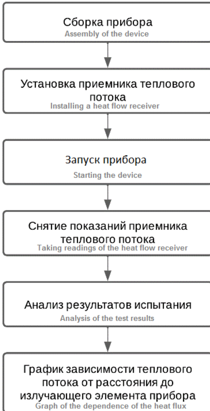
Рис. 1. Методика экспериментального определения эталонной величины плотности теплового потока прибора
