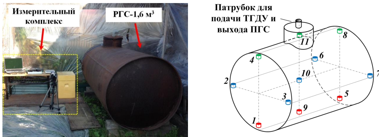
Рисунок 3. Внешний вид РГС-1,6 м 3 и схема размещения датчиков концентрации кислорода (11 шт.) в экспериментальном объеме
