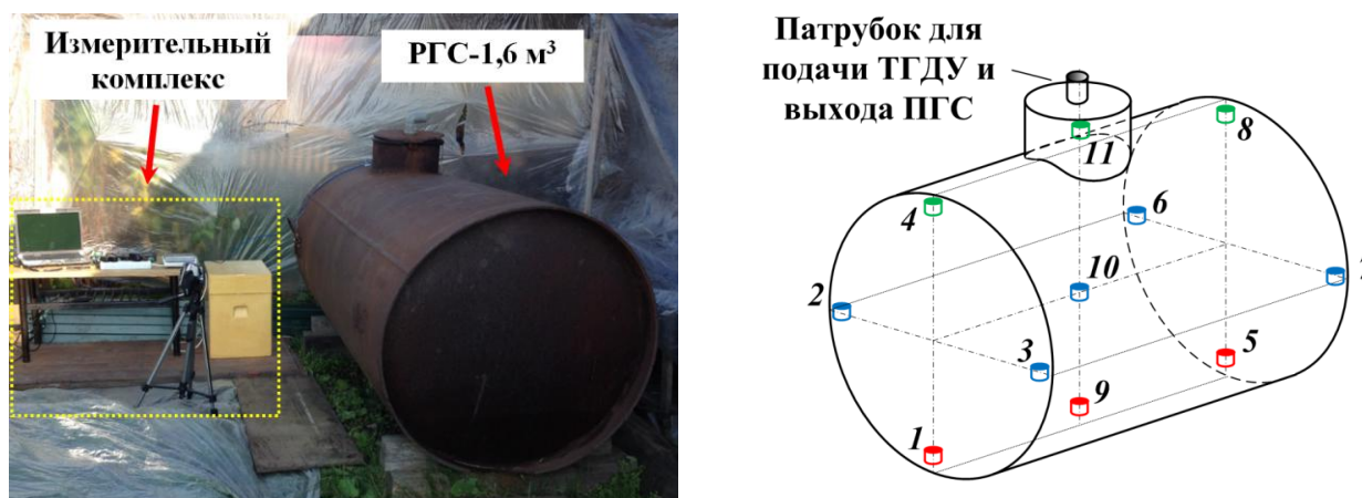
Рисунок 3. Внешний вид РГС- 1,6 \text{ м}^3 и схема размещения датчиков концентрации кислорода (11 шт.) в экспериментальном объеме
