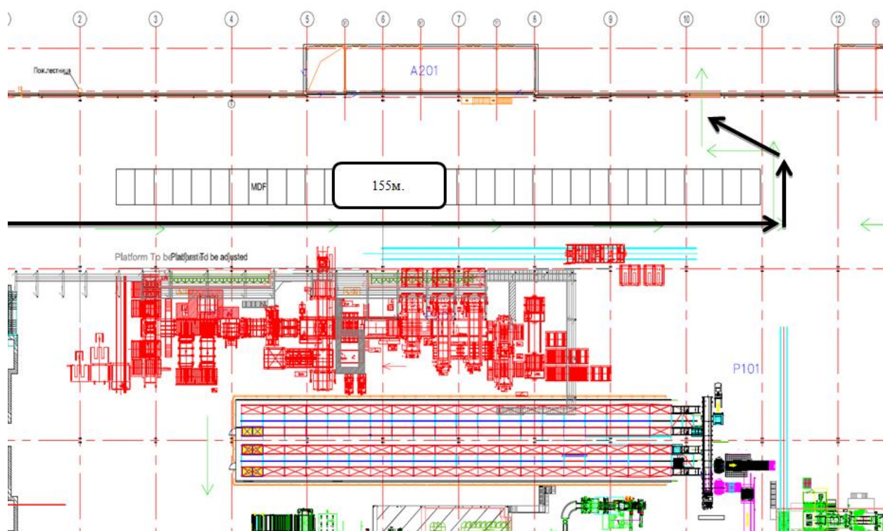
Рисунок 4. Эвакуационный выход из производственного помещения, блокируемый опасными факторами пожара по сценарию 2
