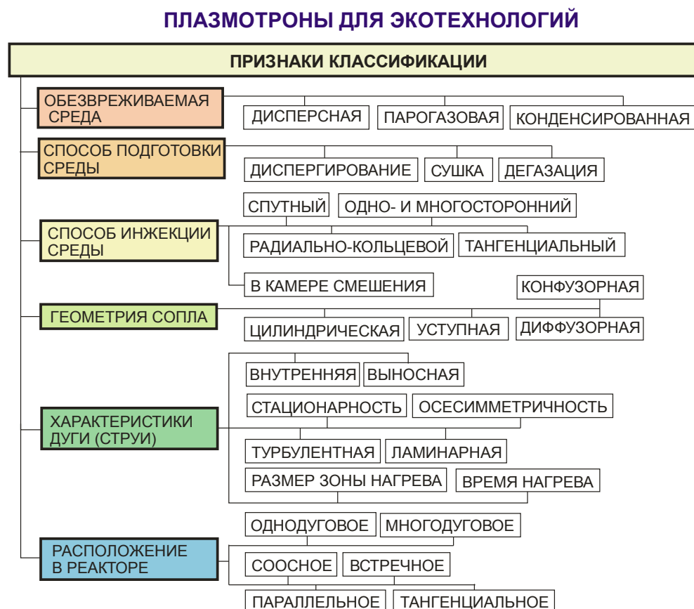
Рисунок 1. Функциональные и конструктивные признаки классификации плазмотронов для экотехнологий
