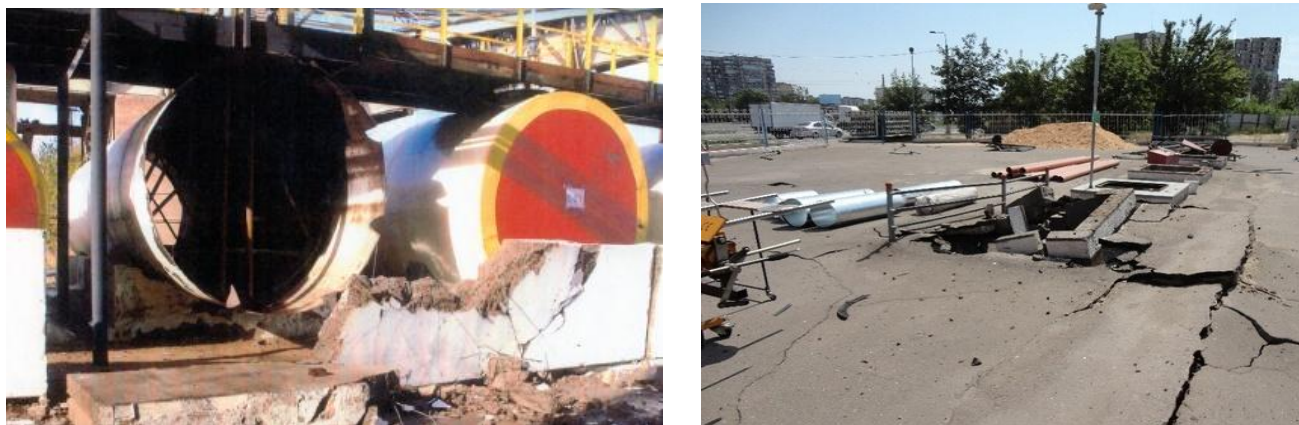
Рисунок 1. Примеры последствий взрыва наземного и подземного РГС в период их ремонта [1]
